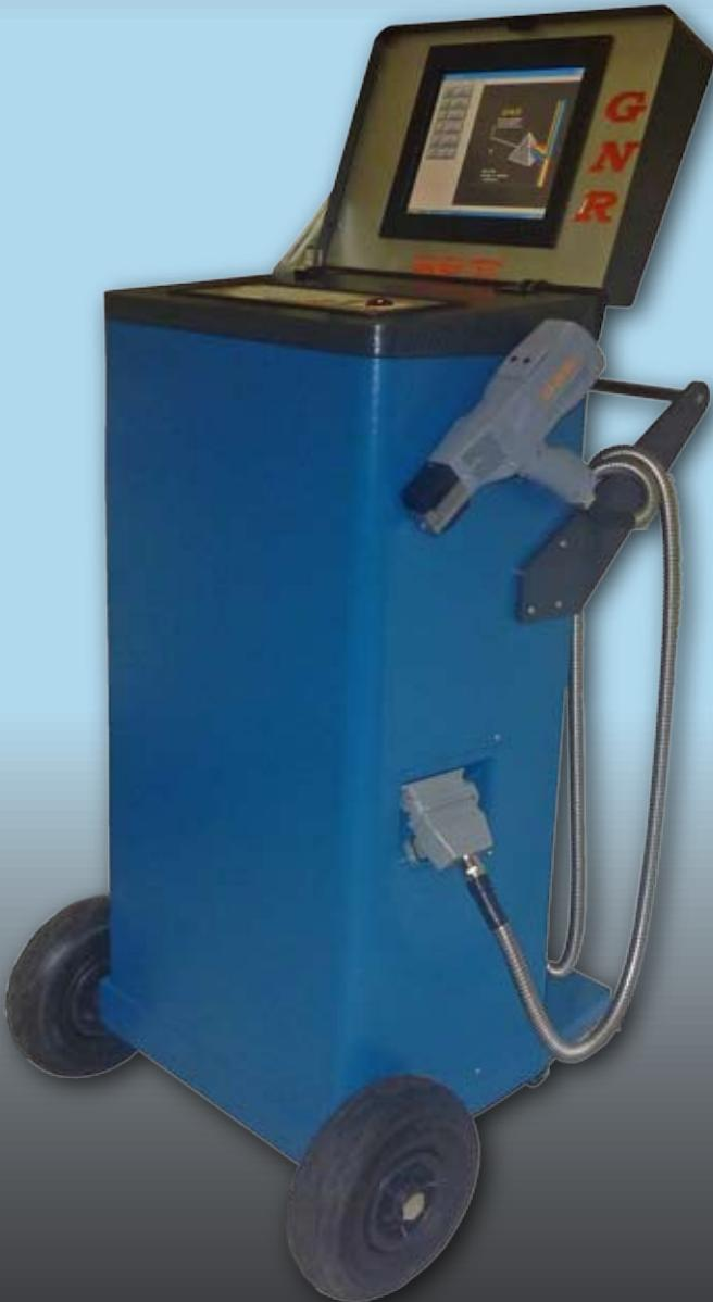
**METAL TEST** spettrometro portatile per analisi in loco equipaggiato con sorgenti di eccitazione scintilla-arco. Può operare in tre differenti modi: cernita (passa/non passa per comparazione), analisi e grado di identificazione.
