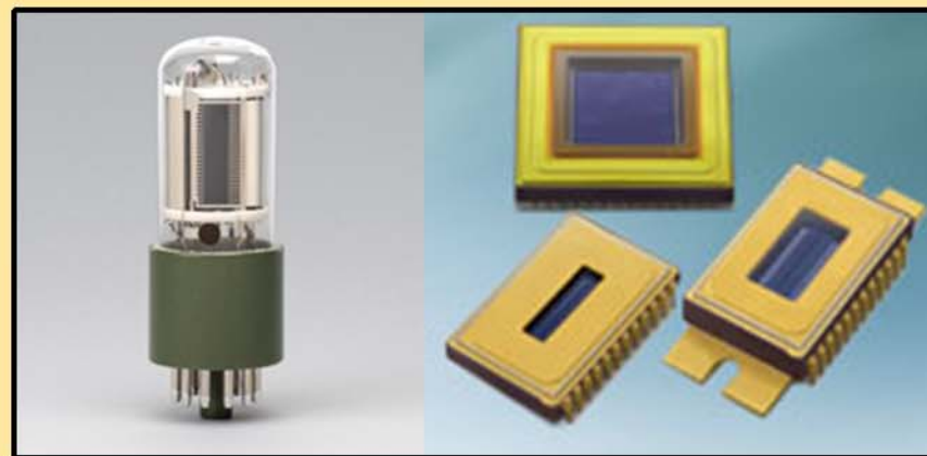
Figuur 1 Een voorbeeld van een Photo Multiplier Tube (l) en een Charged Coupled Device (r). (Zie voor meer informatie: sales.hamamatsu.com en learn.hamamatsu.com )
